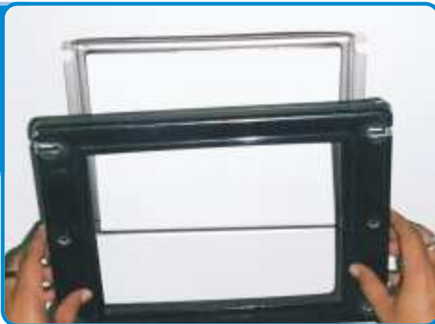
ภาพที่ 22 การวางกระดาษกรองในเครื่องเก็บตัวอย่างอากาศชนิดไฮวอลุ่ม
