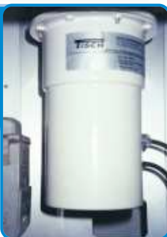
ภาพที่ 2 มอเตอร์สำหรับดูดอากาศให้ไหลผ่านกระดาษกรอง
