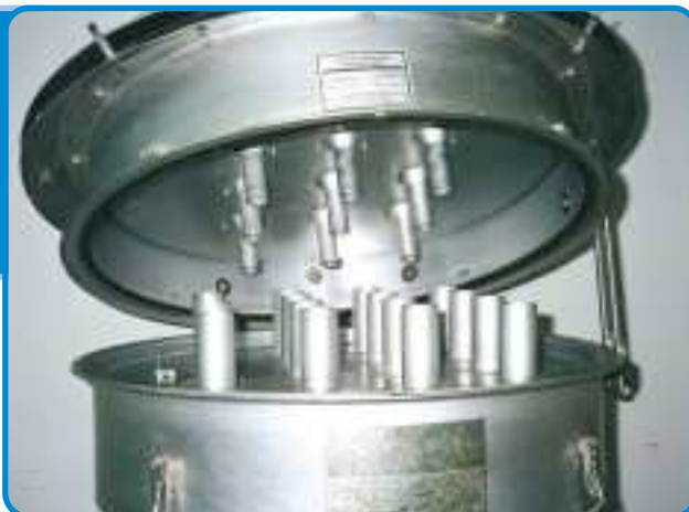
ภาพที่ 24 หัวคัตขนาดฝุ่นละอองขนาดไม่เกิน 10 ไมครอน
