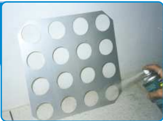
ภาพที่ 27 การพ่น Silicone Grease บนแผ่นดักฝุ่นละอองขนาดใหญ่กว่า 10 ไมครอน
